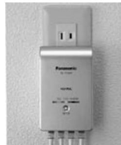
図3：スイッチング・ハブ内蔵PLCモデム （松下電器産業製BL-PA204）
