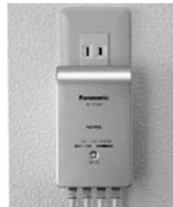
図3：スイッチング・ハブ内蔵PLCモデム
