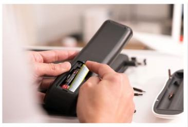
ノバルス社 IoT 乾電池カバー MaBee®を TV リモコンに挿入する様子
